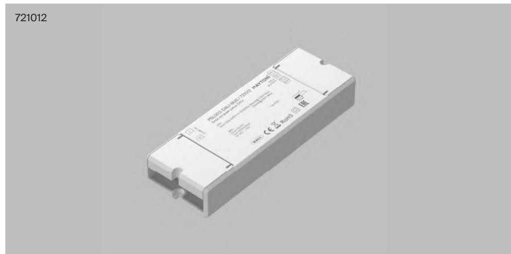
Универсальный источник питания DALI обладает компактными размерами и широким диапазоном входного напряжения 100–240В переменного тока и выходным током 250 мА для питания шины DALI. Питание DALI отличается высокой надежностью и стабильностью при перегрузке по току.
